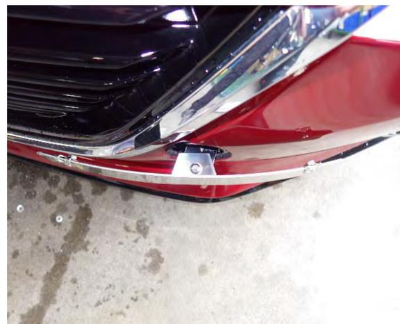
4、挟みナットをナンバーステーに挟み、ナンバーを取り付けます。
