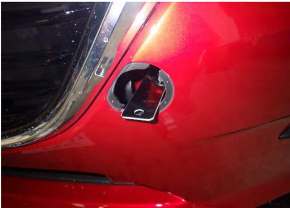
3、ナンバーステーを付属の M6 ボルトナットで取り付けます。
